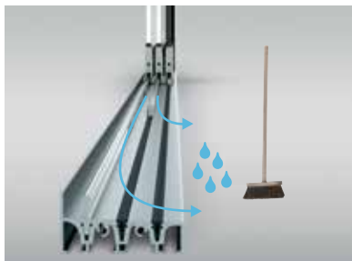
Afwatering en reiniging Vrije afwatering en eenvoudige reiniging van de onderrail dankzij de schuine onderconstructie en de ingekorte loopvlakken.
